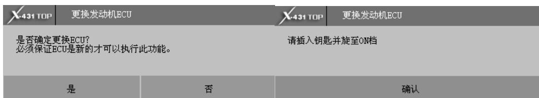
2. 更换发动机 ECU，无需输入 VIN 码和 PIN 码，只要发动机 ECU 为全新发动机 ECU，即可匹配成功，提示信息如下：
