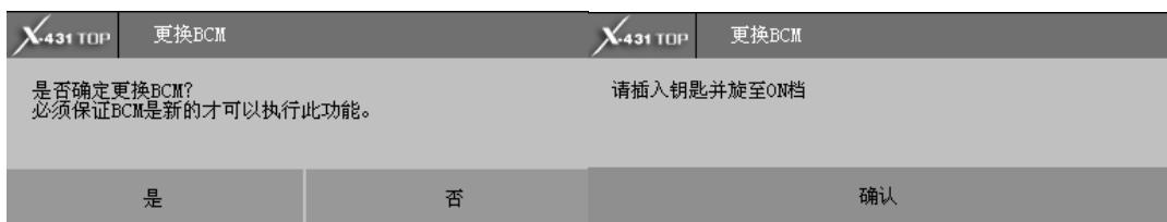
2. 此时也需要输入 PIN 码和 VIN 码，并且输入的 PIN 码必须和发动机 ECU 的 PIN 相符合，否则依然无法成功，按设备提示输入 VIN 码和 PIN 码，具体操作步骤同匹配整套系统。
